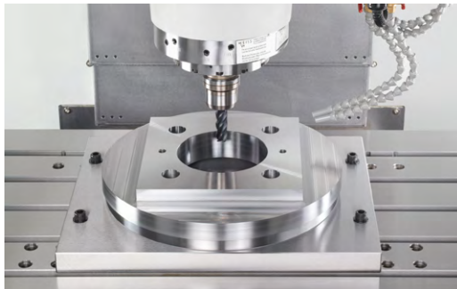
Präzisionsbearbeitung eines Testwerkstücks auf der PRO.E3 mit Hochgenauigkeitspaket
